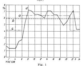
Wirkverlust in % der übertragenen Wirkarbeit. Verlauf über einen Werktag
