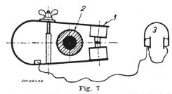
Anlegen des Abhorchgerätes an ein Einleiterkabel 1 Abhorchgerät mit zusammengepressten Elektromagnetpolen; 2 Einleiterkabel; 3 Kopfhörer
