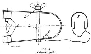
1 Elektromagnete; 2 freie Elektromagnetpole; 3 Rückschlusseisen; 4 Stellschraube; 5 Verbindungsdose; 6 Kopfhörer
