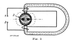
Kraftlinienverteilung von Bleikabeln mit Eisenarmierung bei angelegtem Elektromagnet 1, 2 Kopfhöreranschluss; 3 Armierung
