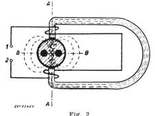
Kraftlinienverteilung von Bleikabeln ohne Armierung bei angelegtem Elektromagnet A-A, B-B Achsen des Wechselfeldes; 1,2 Kopfhöreranschluss
