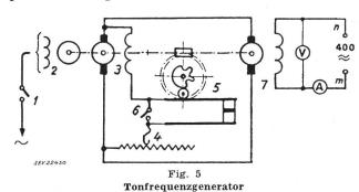
lter; 2 Antriebsmotor (umschaltbar); 3 Erreger-Regelwiderstand; 5 automatischer Unterbrecher; 5 Überbrückungsschalter; 7 Generator 1 Motorschalter; 2
