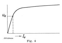
Leerlaufmagnetisierungskurve eines Stromwandlers  $I_e$  Erregerstrom;  $U_a$  am Spannungsdifferential-Relais eingestellte Ansprechspannung
