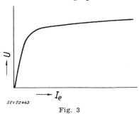
Leerlaufmagnetisierungskurve eines Stromwandlers U Spannung am offenen Wandler;  $I_{\sigma}$  Magnetisierungsstrom
