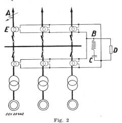
Sammelschienenschutz mit Spannungsdifferential-Relais A «Aussen» liegende Kurzschlußstelle; B Spannungsdifferential-Relais; C Kondensator für die Sperrung des Gleichstroms bei Ausgleichsvorgängen; D Spannungsabhängiger Widerstand zur Begrenzung der Wandler-Sekundärspannung; E Übersättigter Wandler
