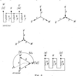
Ermitteln der räumlichen Wicklungsschaltung aus einer Schaltgruppe Yd7, wenn die Oberspannungsanschlüsse um 180° gedreht werden Bezeichnungen siehe Fig. 5
