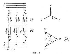
Schaltgruppe eines Transformators mit der Wicklungsschaltung Yd5 (C2), bei vertauschten Anschlüssen
