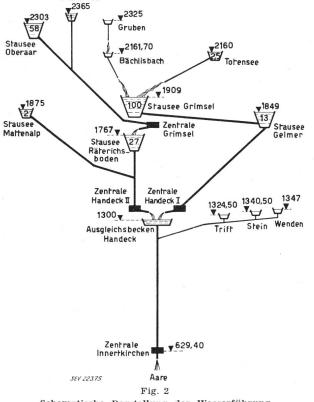
Schematische Darstellung der Wasserführung
