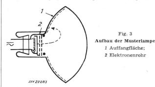
Kathode ist indirekt beheizt und der Heizdraht so bemessen, dass er direkt an Netzspannungen von 110 bzw. 220 V angeschlossen werden darf. Die Kathode braucht nicht so viele
