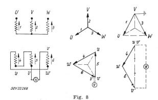
Vektordiagramme bei gesundem und erdschlussbehaftetem Netzbetrieb
