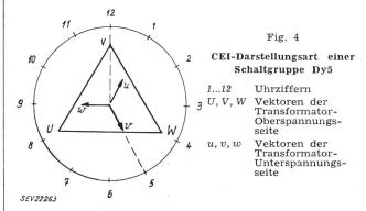
Wicklungsstränge von Ober- und Unterspannungsseite angibt. Die erwähnte Kennzahl wird wie folgt ermittelt: Man bringt den zu betrachtenden Vektor der Oberspannungsseite mit der Ziffer einer Uhr zur Deckung und stellt dabei fest, um wieviele Stunden, d. h. Einheiten von 30° (360: 12 = 30) der entsprechende Sekundärvektor gegenüber dem Primärvektor verschohen ist (Fig. 4).
