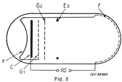
Schematischer Aufbau einer selbststabilisierenden Lampe  $^1$  Auffangfläche  $^F$  Heizdraht der Kathode;  $^C$  Kathode;  $^G$ ,  $^G$ ,  $^G$  Gitter;  $^G$
