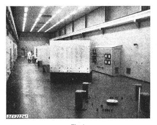
Fig. 1 Vier Untersuchungskästen für hochaktive Metallstücke Die Proben werden durch Kanäle in die abgeschirmten Innenräume eingeführt und dort durch von aussen bediente Apparaturen bearbeitet und gemessen
