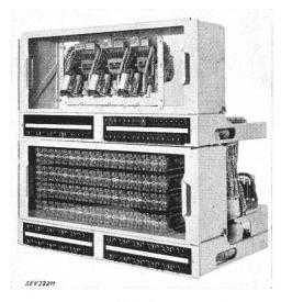
Fig. 7 Doppel-Stromkreiseinheit, obere mit Suchern, untere mit Relais ausgerüstet
