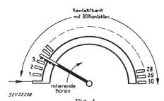
Fig. 4 Anordnung der festen Kontakte und der beweglichen Bürsten beim Sucher nach Fig. 2
