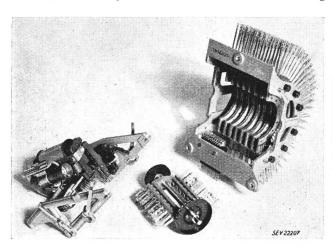
Fig. 3 In Kontaktbank, Bürstenwagen und Antrieb zerlegter Sucher nach Fig. 2
