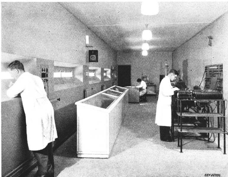
Fig. 4 Beobachtungsraum Links: die den Prüfzellen zugewandeten Schlitzfenster; rechts: die Oszillographen
