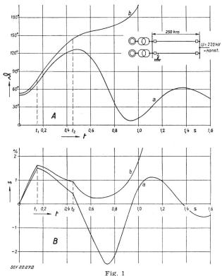
Änderung des Polradwinkels (A) und des Schlupfes (B) bei zweipoligem Erdschluss
