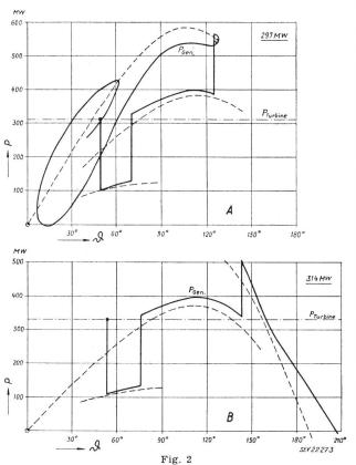
Leistungsverlauf an der Welle während der Störung
