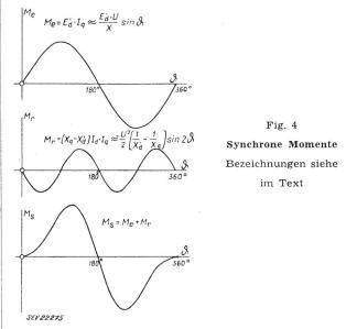
Unterschied besteht darin, dass der Gipfel etwas breiter ist, da man wegen der Ungleichheit von Längs- und Querachse genau genommen die Überlagerung der Charakteristiken zweier Asynchronmotoren mit etwas verschiedenem Kippschlupf bekommt.
