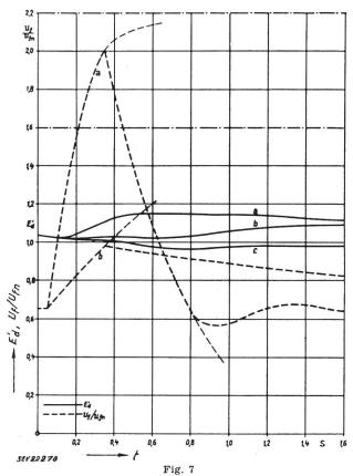
Verlauf von Erregerspannung und Polradfluss
