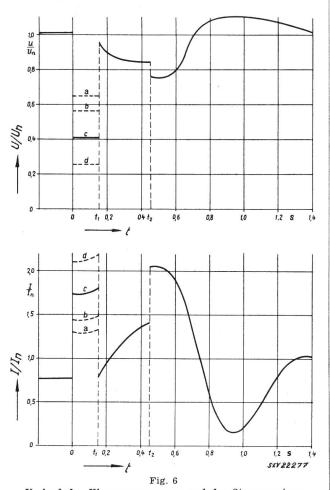
Verlauf der Klemmenspannung und des Stromes eines Generators während der Störung U/Un Klemmenspannung bezogen auf Nennspannung; I/In Generatorstrom bezogen auf Nennstrom; t Zeit
