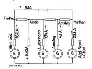
Fig. 2 Stromverteilung im Mitsystem
