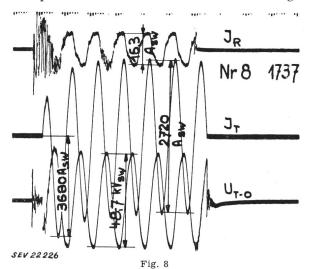
Oszillogramm von Versuch 8. Erdschlußstrom und Phasenspannung von Phase T sowie Strom Phase R der Leitung Airolo—Mörel
