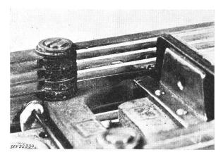
Fig. 12 Linienrelais mit Lichtbogenspuren
