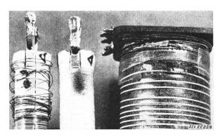
Fig. 11 Zerstörte Widerstände und Wicklungen
