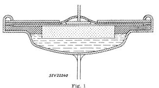
Schnitt durch einen gesinterten Tantal-Elektrolytkondensator
