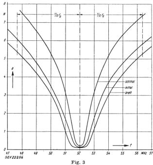
Dämpfungskurven eines Nebenwellenfilters für verschiedene Bandbreiten bei 52 MHz
