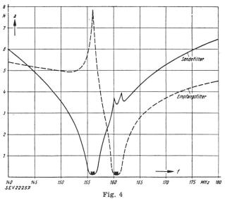
Dämpfungskurven einer Antennenweiche für den 2-m-Verkehrsfunk in fahrbaren Anlagen Bezeichnungen siehe Fig. 3
