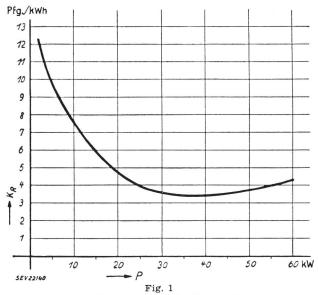
Anhaltskurve für Röhrenkosten  $K_R$  bezogen auf die Generatorausgangsleistung P bei Vollast
