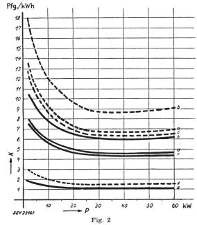
Laufende Kosten K der Energie und des Röhrenverschleisses in Abhängigkeit von der Generatorausgangsleistung P bezogen auf Anwärmegewicht
