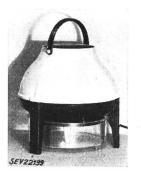
Apparat gemäss Abbildung, zum Zerstäuben von Wasser und anderen Flüssigkeiten für Luftbefeuchtung, Desinfektion, Inhalation und Schädlingsbekämpfung. Gekapselter Einphasen-Kurzschlussankermotor mit Hilfswicklung und Seriekondensator. Motor, Kondensator und Klemmen in zweites Gehäuse aus Isolierpreßstoff eingebaut. Der Motor treibt 4 Schleuderteller an, wovon der unterste mit Ventilatorrippen versehen ist. Durch Fliehkraftwirkung wird
