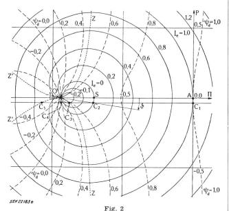
Arbeitsdiagramm einer Synchronmaschine
