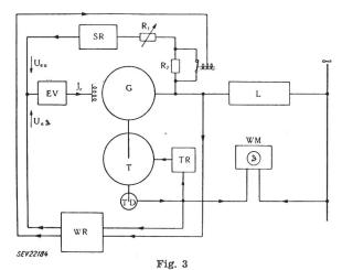
Prinzipschaltung eines Generators mit winkelabhängiger Regulierung
