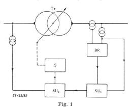
Prinzipschema der Blindleistungsregulierung an Kuppeltransformatoren
