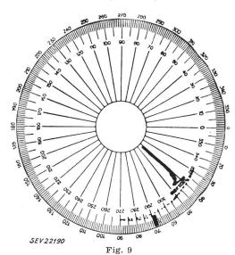
Verlauf des Lastwinkels des Kompensators bei plötzlicher Zuschaltung des Verbrauchers im Schema nach Fig. 8
