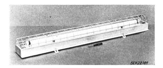
gehäuse montiert und durch Plexiglashaube und Gitter geschützt. Haube und Gitter mit Sonderverschluss verschraubt. Verriegelung schaltet beim Abheben der Plexiglashaube das Netz einpolig aus. Lampenfassungen mit Federung in Längsrichtung. Stopfbüchsen für die Leitereinführung. Anschlussklemmen gegen Selbstlösen gesichert. Erdungsklemme innen und aussen an der Armatur.
