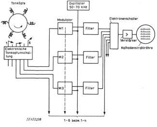
Fig. 4 Schema der Schaltung für Simultanbetrieb
