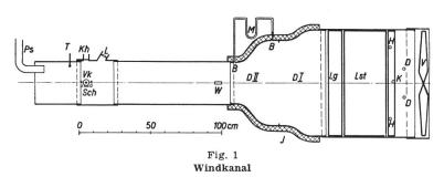
Bohrung 2 mm Dampfeinspritzung Venturi-Düsen DI, DII H J Heizwicklungsträger Watteisolation Abschluss der Kühlschlange Kamerahalter K Kh L Beleuchtungslinse Leitgitter Lg Lst M Ps Leitstern Manometer Luftentnahme für Psychrometer Sch T V Vk Schiene an der Aussenwand Thermometer Ventilator Versuchskörper Schlitz für Wasserzerstäuber
