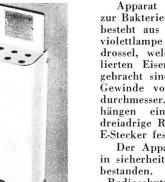
Apparat gemäss Abbildung, zur Bakterientötung. Der Apparat besteht aus einer kleinen Ultraviolettlampe und einer Vorschaltdrossel, welche in einem ventilierten Eisenblechgehäuse untergebracht sind. Lampensockel mit Gewinde von 16,5 mm Aussendurchmesser. Apparat zum Aufhängen eingerichtet. Zuleitung dreiadrige Rundschnur mit 2 P + E-Stecker fest angeschlossen.
