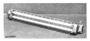
mit cosq-Kondensator entsprechen der Schutzart «erhöhte Sicherheit». Unterbrechungseinrichtung gewährleistet spannungsloses Auswechseln der Lampen. Verschraubungen mit Dreikantmuttern. Störschutzkondensator vorhanden.
