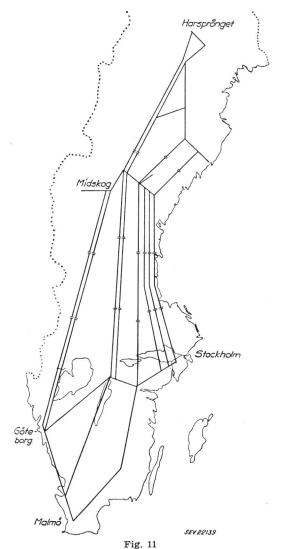
Geplanter Endausbau des schwedischen 380-kV-Netzes
