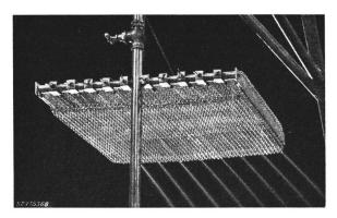
Fig. 10 Abschirmung der Düsenstrahlen Gitterlänge 60 cm
