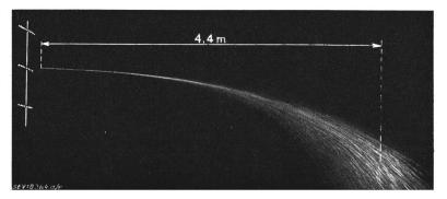
Fig. 4 Strahlverlauf bei 1,4 kg/cm² Überdruck
