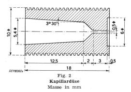
suchen. Die günstigsten Resultate ergab die in Fig. 2 dargestellte Kapillardüse. Diese Düse erlaubt eine mechanisch sehr genaue Herstellung, bewährt sich hinsichtlich Reproduzierbarkeit des Strahlverlaufes und ergibt eine natürliche Tropfengrösse und eine bedeutend kleinere Streuung des Einfallwinkels als die Streudüsen.
