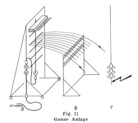
Von links nach rechts: Rechengerüst mit Rechen; Zieleinrichtung; Prüfobjekt H Regulierhahn, F Filter, M Manometer
