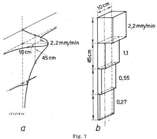
Horizontalkomponente der Niederschlagsintensität einer Düse im Abstand von 4,4 m auf einer vertikalen Schnittebene
