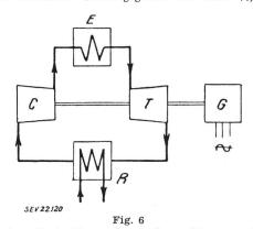
Schema einer Gasturbinenanlage mit geschlossenem Kreislauf E Lufterhitzer Weitere Bezeichnungen siehe Fig. 1 und 3
