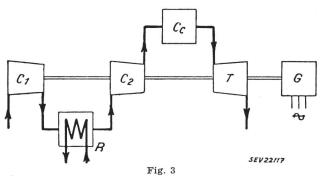
Schema einer Gasturbine mit einem Zwischenkühler
