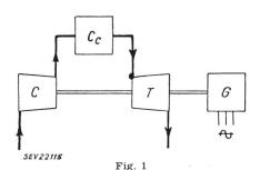
Einfachstes Schema einer Gasturbinenanlage C Kompressor;  $C_c$  Brennkammer; T Turbine; G Generator
