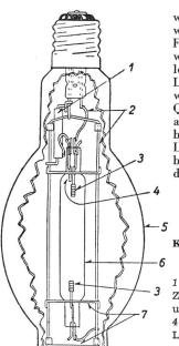
Im Prinzip ist die Betriebsweise dieser Lampe die gleiche wie bei den röhrenförmigen Fluoreszenzlampen: Einerseits werden die ultravioletten Strahlen durch den Leuchtstoff in Licht umgewandelt, anderseits wird ein Teil des von der Quecksilberentladung direkt ausgestrahlten Lichtes absorbiert, so dass das ausgesandte Licht die Zusammensetzung beider Lichtarten ist. Wie die meisten Entladungslampen
