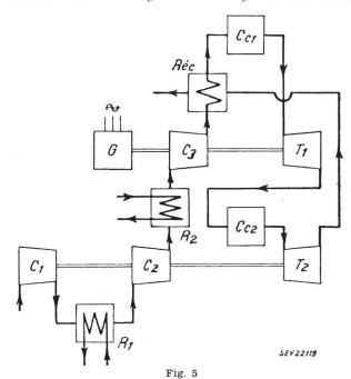
Schema einer Gasturbinenanlage mit zwei Zwischenkühlern, zwei Brennkammern und einem Rekuperator (Generator von der Hochdruckturbine angetrieben) Bezeichnungen siehe Fig. 1, 2, 3
