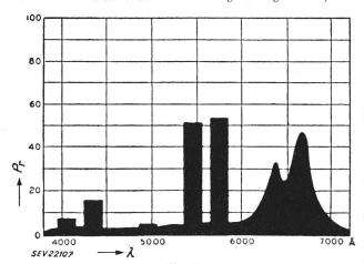
Fig. 2 Spektrale Energieverteilung der sichtbaren Strahlung einer Quecksilberlampe mit fluoreszierendem Kolben  $\lambda$  Wellenlänge in Ångström 1);  $P_r$  relative Energie
