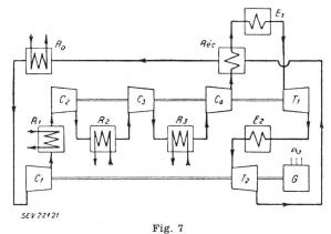
Schema einer Gasturbinenanlage mit geschlossenem Kreislauf, mit zweifacher Zwischenkühlung und einfacher Zwischenerhitzung
