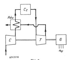
Fig. 2 Schema einer Gasturbine mit Rekuperator Réc Rekuperator, Wärmeaustauscher Weitere Bezeichnungen siehe Fig. 1
