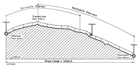
Fig. 2 Längenprofil Oberwald-Oberaar Anlage 2
