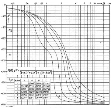
Blatt 10 Phasenmass der Spannungsübersetzung eines vierkreisigen Filters
