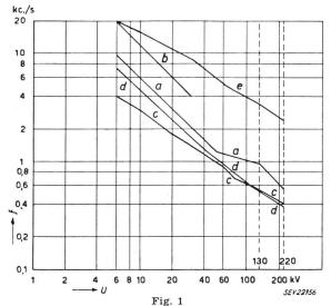
Eigenfrequenz f der wiederkehrenden Spannung U entsprechend verschiedenen Vorschlägen
