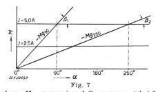
Verlauf von Messmoment und Gegenmoment bei linearer Skala mit einem Skalenwinkel von 90° und 250° M Drehmoment; & Skalenwinkel; I Messgrösse (Strom); -Mg(90) Gegenmoment beim 90°-Instrument; -Mg(250) Gegenmoment beim 250°-Instrument Weitere Bezeichnungen siehe im Text
