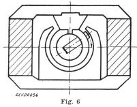
Drehspulmagnet mit Hakenpol zur Erzielung eines Skalenwinkels von  $250^{\circ}$
