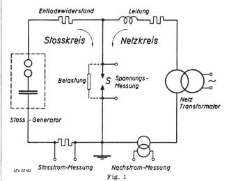
Prinzipschema der Versuchsanlage S zu untersuchende Lichtbogenstrecke
