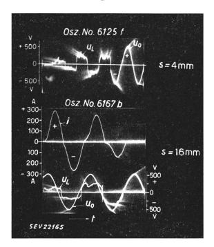
Oszillogramm-Beispiele von Überschlägen zwischen zwei blanken Cu-Drähten in freier Luft s Schlagweite;  $u_{\scriptscriptstyle 0}$  Klemmenspannung (Spannung an den Elektroden ohne Lichtbogen);  $u_L$  Lichtbogenspannung; i Lichtbogenstrom
