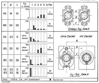
ten Sicherungselement-Typen und die Messergebnisse dargestellt. Um für den Vergleich immer eindeutig die kleinste Schlagweite zu erreichen, erfolgte der Anschluss der Zuleitungen an den Gewinderingen. Aus der graphischen Darstellung der prozentualen Verteilung der Nachstromdauer geht vor allem hervor, dass bei Elementen mit Deckel die Nachstromdauer bedeutend kleiner ist als bei offenen Elementen. Der Abstand der Elemente ist dagegen für das Fliessen des Nachstromes von geringerer Bedeutung.
