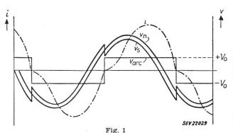
Form der verschiedenen Strom- und Spannungskurven bei einer Gasentladungslampe
