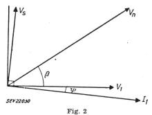
Vektorbild (Effektivwerte) der Spannungen  $V_n$  Netzspannung,  $V_s$  Drosselspulenspannung, Fourierkomponente mit Frequenz  $\omega$  der Lampenspannung  $v_{arc}$ , und des entsprechenden Lampenstromes I
