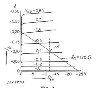
Kollektorcharakteristik und Arbeitskennlinie eines Leistungs-Transistors
