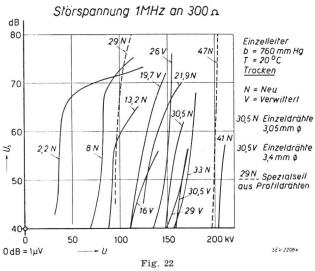
Radio-Störspannungen verschiedener trockener Leiterseile  $U_s$  Störspannung; U Versuchsspannung
