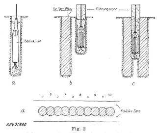
Schema zur Herstellung einer Spundwand
