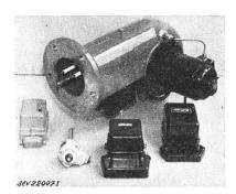
durch Druckpumpe und Düse. Zündung mit Hochspannung. Antrieb durch ventilierten Drehstrom-Kurzschlussankermotor. Steuerung durch Photozellen-Flammenwächter, Schaltautomat und Kesselthermostat «Landis & Gyr». Motorschutzschalter «Sprecher & Schuh», Zugluftregulierung «Landis & Gyr».
