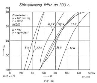
Radio-Störspannungen verschiedener Leiterseile unter Regen
