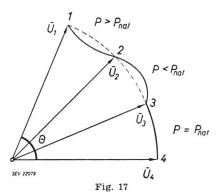
Wirkung von Spannungsstützpunkten längs einer langen Übertragungsleitung bei verschiedenen Belastungen
