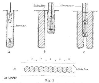
Schema zur Herstellung einer Spundwand
