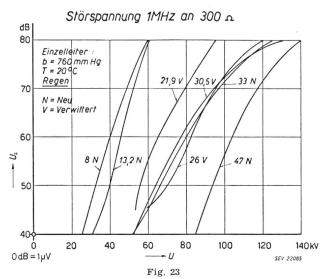
Radio-Störspannungen verschiedener Leiterseile unter Regen
