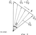
Strom und Spannung auf der kurzen Leitung  $Z_1$ : Leitungsimpedanz;  $U_X$  Spannung im Leitungspunkt x
