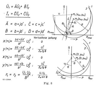
Kreisdiagramm der übertragenen Leistungen der langen
