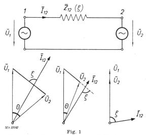
Prinzip der Energieübertragung mit Wechselstrom zwischen den Punkten 1 und 2
