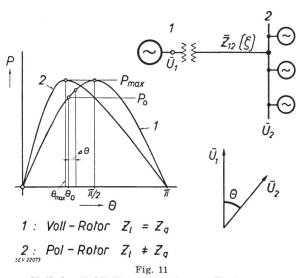
Statische Stabilität einer einfachen Übertragung Leistungskurve eines Vollpol-Generators Leistungskurve eines Generators mit ausgeprägten Polen
