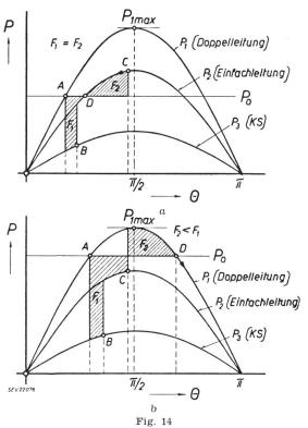
Dynamische Stabilität einer einfachen Übertragung beim Kurzschluss eines Stranges einer Doppelleitung a ohne Kurzschluss-Fortschaltung; b mit Kurzschluss-Fortschaltung
