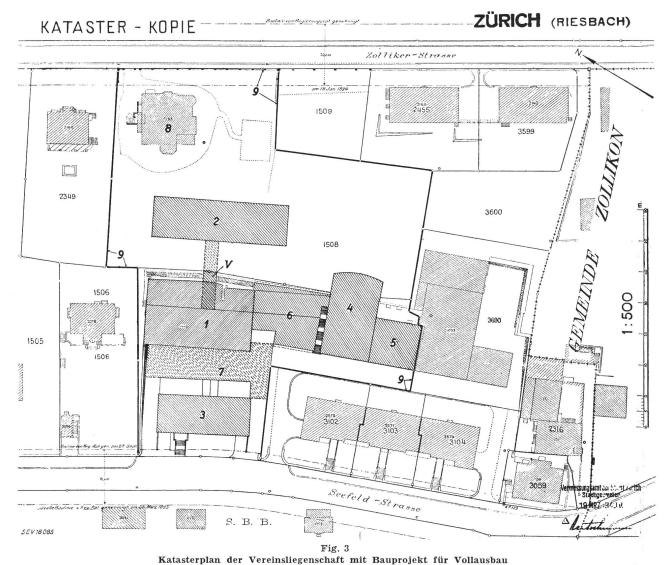
1 Bestehendes Vereinsgebäude (Mittelbau); 2 Neues Laboratoriumsgebäude (Ostbau); 3 Neuer Westbau; 4 Neues Hochspannungslaboratorium; 5 «Restbau» (Südbau); 6 Neuer Zwischenbau; 7 Vorbau zum Mittelbau (wird nicht ausgeführt); 8 Wohnhaus Zollikerstrasse 238; 9 Liegenschaftgrenze; V Verbindungsgang (Mittelbau-Ostbau)
