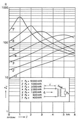
Fig. 11 Tonfrequenzausbreitung auf einem 6-kV-Drehstromkabelnetz Eingangsimpedanz pro Phase  $Z_1$  in Funktion der Leitungslänge  $\iota$  bei Vollast
