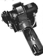
An einem Heizkessel ist ein Brenner des kleinsten Typs, welcher sich hauptsächlich für Einfamilienhäuser eignet, montiert und wird im Betrieb vorgeführt. Dank des speziellen Brennerkopfes ist es möglich, die Flamme dem Feuerraum für eine maximale Ausnützung der Wärme anzupassen.
