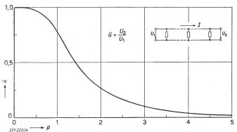
Fig. 4 Spannungsübersetzung  $\ddot{u}$  einer Leitung zwischen Ende und Anfang  $p = l \bigvee \omega L \, \overrightarrow{G} \;\; \text{Parameter}$
