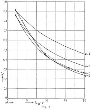
Spannungsverhältnis  $\ddot{u}x' = Uz'/U_1$  eines Tranformators in Funktion der Frequenz f in kHz und der relativen Kurzschluss-Spannung  $\varepsilon_{k}$  bei 50 Hz in %
