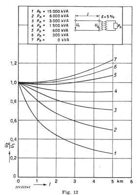
Parameter: Nennleistung  $P_n$  des Transformators am Ende der Leitung
