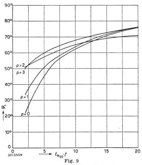
Phasenwinkel  $\varphi_1$  der Eingangsimpedanz  $Z_1$  eines Tranformators in Funktion der Frequenz f in kHz und der relativen Kurzschluss-Spannung  $\varepsilon_{k$  50 bei 50 Hz in %
