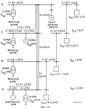
Ermittlung der Eingangsimpedanz Z und des Spannungsverhältnisses  $\ddot{u}$  in einem städtischen 6-kV-Kabelnetz
