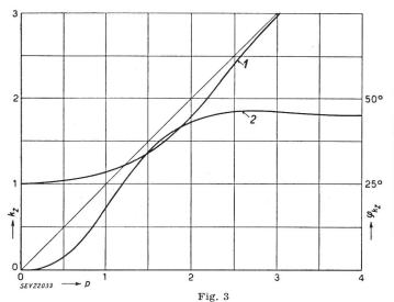
Eingangsimpedanz  $Z_1$  einer belasteten Niederspannungsleitung bei Tonfrequenz, bezogen auf die Leitungsimpedanz  $Z_{10}$  bei 50 Hz
