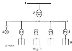
Ausbau eines Energieverteilnetzes Hochspannungszuführung. 2 Unterstation 3 Mittelspannungsverteilung, 4 Signalgenerator, 5 Transformatorenstation, 6 Niederspannungsverteilung zum Verbraucher
