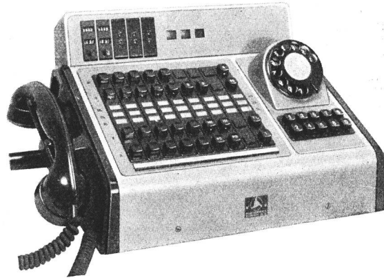
Fig. 2 Vermittlungsstation mit Blocktasten
