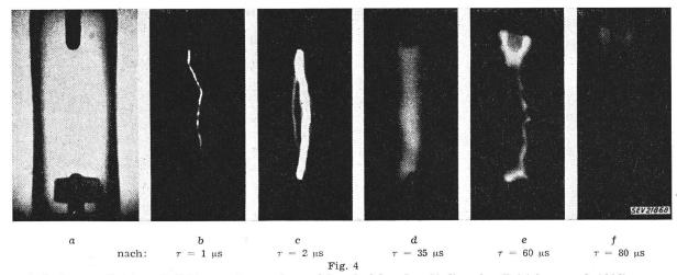
Aufnahmen mit 0,1  $\mu$ s Belichtungszeit von den aufeinanderfolgenden Stadien des Entstehens und Abklingens der Entladung in einer Blitzlampe a ist ein statisches Photo des Elektrodensystems; b...f sind mit zunehmender Verzögerungszeit  $\tau$  nach dem Zünden des Blitzes hergestellt
