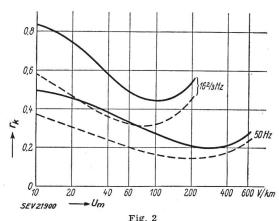
Reduktionsfaktor r in Abhängigkeit von der induzierten Mantelspannung  $U_m$ Normal-Bandstahl
