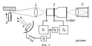
Anordnung für die Verwendung eines Bildwandlers als schneller photographischer Verschluss
