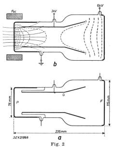
Schnitt durch die Bildwandlerröhre mit dem elektronenoptischen System
