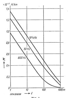
Fig. 1 Gegeninduktivität M für verschiedene Frequenzen in Abhängigkeit vom Abstand l
