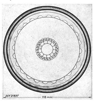
Fig. 1 Querschnitt durch das 380-kV-Kabel
