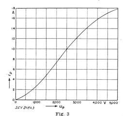
Strom-Spannungscharakteristik einer neuen Röhre  $i_p$  Strom;  $u_p$  Spannung
