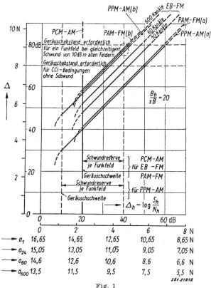
Geräuschabstand A im Sprachkanal in Abhängigkeit vom Rauschabstand  $A_n$  am Empfängereingang Streckendämpfung a für die Kanalzahlen 1, 24, 60, 600
