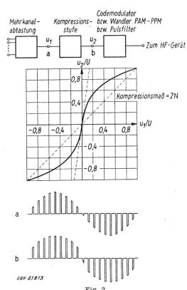
Amplitudenkompression bei Pulsmodulation a nicht komprimiert; b komprimiert
