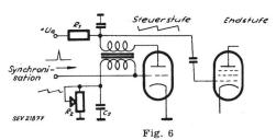
Zeilensynchronisierung durch Einzelimpulse
