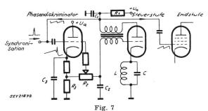
Zeilensynchronisierung durch Phasenvergleich
