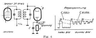
Einfaches System für automatische Verstärkungsregelung
