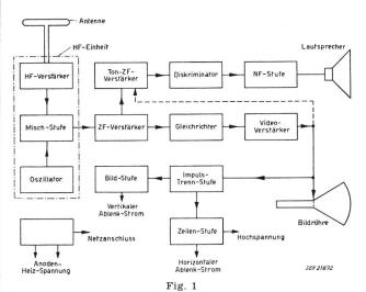
Blockschema eines Fernseh-Empfängers Für Intercarrier-Empfänger gilt die gestrichelt gezeichnete Verbindung, während die direkte Verbindung zwischen ZF-Verstärker und Ton-ZF-Verstärker wegfällt
