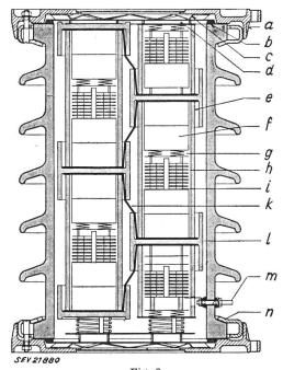
Fig. 2 Längsschnitt durch den unteren Teil eines Überspannungs-ableiters XRSC
