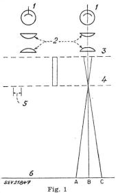
Abtasteinrichtung zur Synchronisierung des Filmtransportes von Flugzeugkameras
