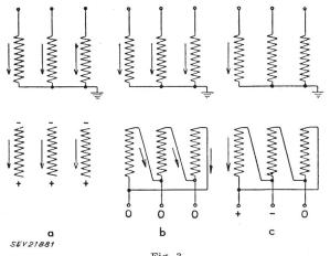
Fig. 3 Magnetisch übertragene Spannungsstösse in einem Stern-Dreieck-Transformator
