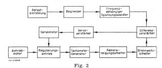
Blockschema der Synchronisierungseinrichtung
