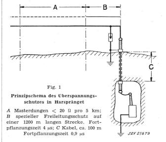
Aus praktischen Gründen mussten die Überspannungsableiter für die Fernleitungen in der Freiluftanlage neben den Kabelendverschlüssen aufgestellt werden und nicht nach den Kabeln in der Transformatorenstation. Diese Anordnung be-
