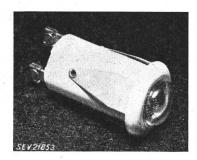
federn dienen zur Befestigung der Glimmlampe in einer Frontplatte (Bohrung 21 mm Durchmesser). Anschluss durch Schraub- oder Lötverbindung. Für Spannungen von 380 bzw. 500 V wird ein zusätzlicher Widerstand von 68 bzw. 120 k $\Omega$ benötigt.
