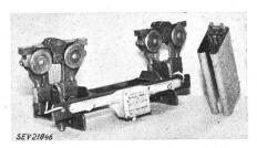
auf die Rollenhalter und von diesen über Kupferlitzen auf die Eisentraverse, an welcher der Motor montiert wird. Die Hängebahn ist für Verwendung in Werkstätten und auf gedeckten Lagerplätzen vorgesehen. Motorleistung bis 2 PS.
