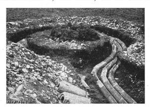
Fig. 4 Kabelschlaufe im Versuchsgelände
