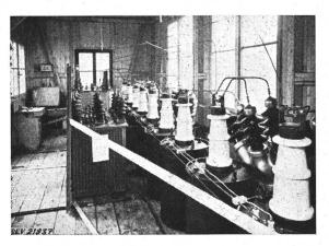
Fig. 5 Prüfeinrichtungen für die Dauerversuche
