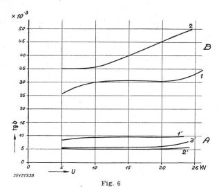
Dielektrische Verlustmessungen an 10-kV-Kabeln,  $3 \times 25$  mm² Cu, nach der Dauerprüfung
