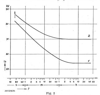
Durchschlagsprüfungen an Gürtelkabeln  $\begin{array}{ccc} 1 & 8\text{-kV-Kabel}, & 3\times 20~\text{mm}^2~\text{Cu} \\ 2 & 10\text{-kV-Kabel}, & 3\times 50~\text{mm}^2~\text{Cu} \\ U \text{ Durchschlagsspannung}; & t \text{ Zeit bis der Durchschlag erfolgte} \end{array}$
