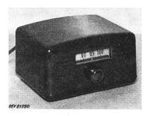
Frequenzbereich 85—103 MHz. Netztransformator mit getrennten Wicklungen. Röhrengleichrichter für die Anodenspannung. Schutz gegen Überlastung durch 2 Kleinsicherungen 60 mA. Je 1 Büchsenpaar für den NF- und Antennenanschluss. Zuleitung Rundschnur mit Stecker, fest angeschlossen. Preßstoffgehäuse mit verschraubter Presspanrückwand.
