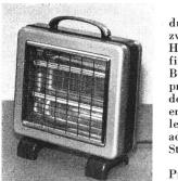
Heizstrahler gemäss Abbildung. Widerstandswendel auf zwei Keramikstäbe gewickelt. Hinter den Heizelementen befindet sich ein Reflektor aus Blech. Handgriff aus Isolierpreßstoff, mit Metall verkleidet. Zwei Kipphebelschalter ermöglichen Betrieb des Strahlers mit 3 Heizstufen. Dreiadrige Zuleitung mit 2 P + E-Stecker, fest angeschlossen.
