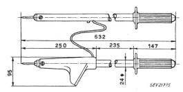
eine U-förmige gasgefüllte Röhre enthält; im weitern ist ein keramischer Widerstand eingebaut; ein solcher Widerstand ist auch im andern Prüfstab vorhanden. Die U-Röhre spricht bei 1000 V an; durch Eindrücken wird die Glimmlampe eingeschaltet, welche unterhalb 200 V anspricht. Da die Verbindung der Prüfspitzen eine galvanische ist, werden Wechselund Gleichspannungen angezeigt.
