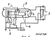
Schematische Darstellung der Kathodenstrahlröhre 1 Elektronenquelle; 2 Kollektorplatten; 3 Ausgang; 4 Polschuhe; 5 Fokussierung
