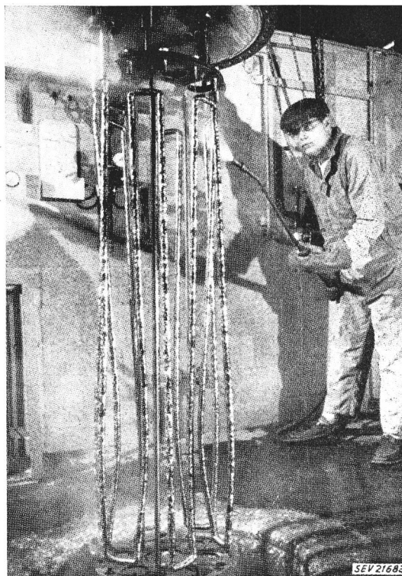
Fig. 1 Zirkonbarren wie sie beim Verfahren nach Van Arkel anfallen ca. 3 cm φ, 15 m lang, ≈ 60 kg
