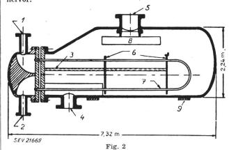
Schnitt durch Dampferzeuger mit schwerem Wasser als Wärmeübertrager
