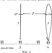
Richtungs-Empfangsdiagramm des Radioteleskops der Ohio State University
