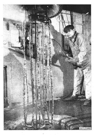
Fig. 1 Zirkonbarren wie sie beim Verfahren nach Van Arkel anfallen ca. 3 cm  $\phi$ , 15 m lang,  $\approx$  60 kg
