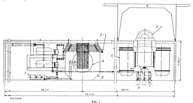
Disposition einer Reaktoranlage mit Flüssigkeit als Wärmeübertrager
