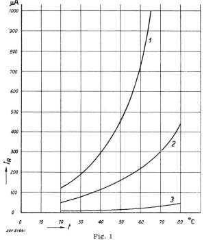
Temperaturcharakteristik von Elektrolytkondensatoren
