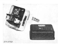
Die Ölfeuerungsapparate haben die Prüfung in Anlehnung an die Schaltervorschriften (Publ. Nr. 119) bestanden. Verwendung: in trockenen und zeitweilig feuchten Räumen.
