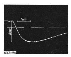
Fig. 3 Spannungsverlauf beim Kippen einer Zinksulfatlösung in einem Glasrohr
