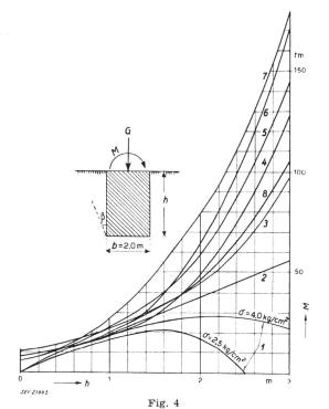
Reaktionsmomente für ein Blockfundament in Funktion der Tiefe nach verschiedenen Berechnungsmethoden
