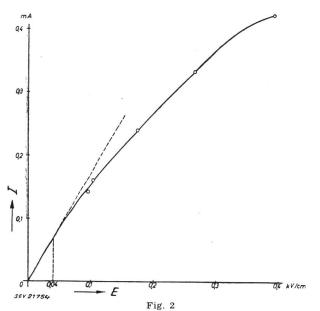
Abhängigkeit des Stromes I von der Feldstärke E bei einem Leitgummistrang von 3,0/6,0 mm, von 1 m Länge und 65 M $\Omega$  Widerstand bei 100 V
