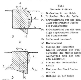
Dabei werden die seitlichen Erdwiderstände nach der klassischen Coulombschen Erddrucktheorie durch Kombination des aktiven und passiven Erddrucks bestimmt.
