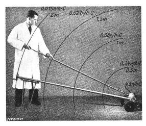
Fahrbarer Transport- und Arbeitsbehälter für radioaktive Strahler
