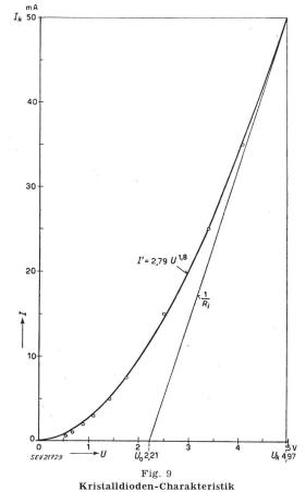
Ersatzkennlinie  $I' = 2,79 \ U^{1,8}$ Messpunkte für 2 Dioden OA 55 in Serie
