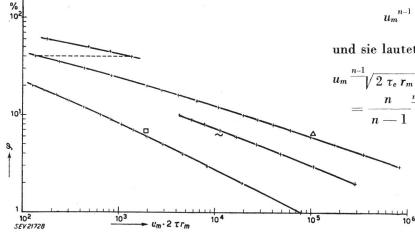
Mit einer Dreieckimpuls-Fehlerkurve ist daher für alle Messinstrumentwerte und Impulsdauern der Fehler in Funktion des Meßspannungswertes  $u_m$  direkt bestimmbar. Für die quadratische Parabel der Kontaktgleichrichter vereinfacht sich die Formel zu
