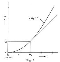
Die allgemeine parabolische Gleichrichtercharakteristik in relativer Darstellung mit  $U_n$  als Bezugsspannung u Gleichrichterspannung; i Gleichrichterstrom; uk Spannung und ik Strom für den Berührungspunkt der Parabel mit der Geraden von Fig. 6b; n Grad der Parabel;  $k_n$  Konstante der  $n^{\rm ten}$  Parabel
