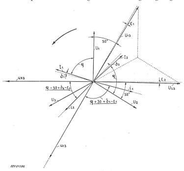
Fig. 1 Vektordiagramm der Wirkungsgradmessung an Synchronmaschinen nach dem Über- und Untererregungsverfahren
