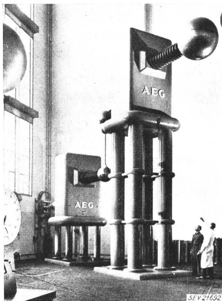
Fig. 1 Prüftransformator im Höchstspannungsfeld
