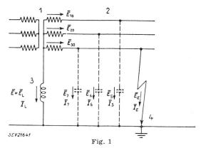
Direkter Erdschluss über einem Ohmschen Widerstand in einem Drehstrom-Hochspannungsnetz mit Löschspule 1 Haupttransformator im Unterwerk; 2 16-kV-Netz; 3 Lösch-
