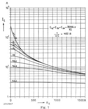
Erdschlußstrom  $I_E$  in Funktion des Ohmschen Widerstandes an der Erdschlußstelle  $R_E$
