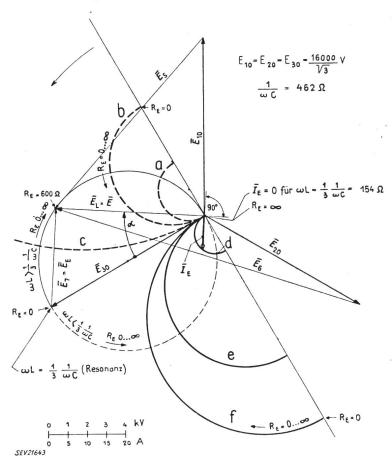
$\bar{E}$  bzw.  $\bar{E}_L$ die E.M.K. zwischen dem Nullpunkt der Haupttransformatoren und der Erde, bzw. die E.M.K. an der Löschspule;
