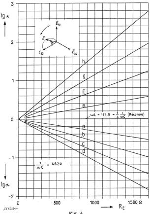
Fig. 4 tg $_{\infty}$  in Funktion des Ohmschen Widerstandes an der Erdschlußstelle für verschiedene Einstellungen der Löschspule  $R_E$  Ohmscher Widerstand an der Erdschlußstelle
