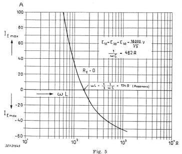
Maximalwert des Erdschlußstromes  $I_{Emax}$  in Funktion des induktiven Widerstandes ωL der Löschspule
