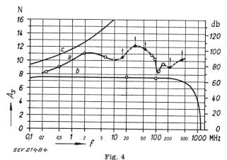
Dämpfungskurven des Laboratoriums mit 4 Fenstern und 80 m² Grundfläche. Störquelle: 200-kW-Sender, 150 kHz...100 MHz
