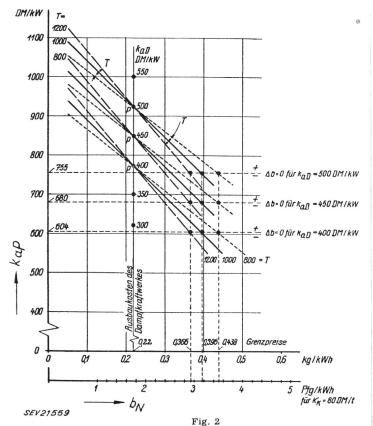
Wettbewerbsfähige Ausbaukosten des Pumpspeicherwerkes in Abhängigkeit vom Preis der benötigten Schwachlastenenergie Die Geraden scheinen um die Punkte p zu drehen; dies rührt daher, dass für  $b_N=0$ ,22 kg/kWh das Produkt  $\Delta$   $b\cdot T$  ungefähr konstant bleibt
