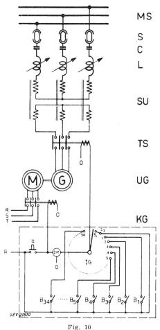
Prinzipschema einer Sendeanlage
