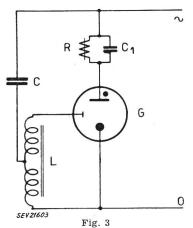
Eingangsschaltung des Ghielmetti-Empfängers Impulsverstärkung durch Kaltkathoden-Gastriode
