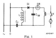
Eingangsschaltung mit Impulsverstärkung durch Speicherung
