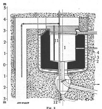
Schwerwasser-Versuchsreaktor, 10 000 kW Wärmeleistung Schnittbild des aktiven Teils
