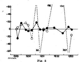
Prozentuale Widerstandsschwankungen von Erdelektroden der Fig. 2 und 3
