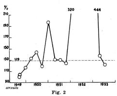
Prozentuale Änderung der Erdungswiderstände der Kontrollelektroden Nr. 2 und 4 der Gruppe unter 50  $\Omega$
