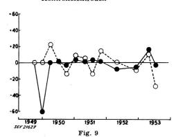
Prozentuale Widerstandsschwankungen von Erdelektroden der Fig. 4 und 5 Bezeichnungen siehe Fig. 8
