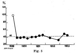
Wie Fig. 4, aber bei elektrolytgelbehandelten Erdelektroden (Nr. 11, 12 und 14)
