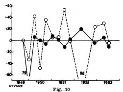
Prozentuale Widerstandsschwankungen von Erdelektroden der Fig. 6 und 7 Bezeichnungen siehe Fig. 8
