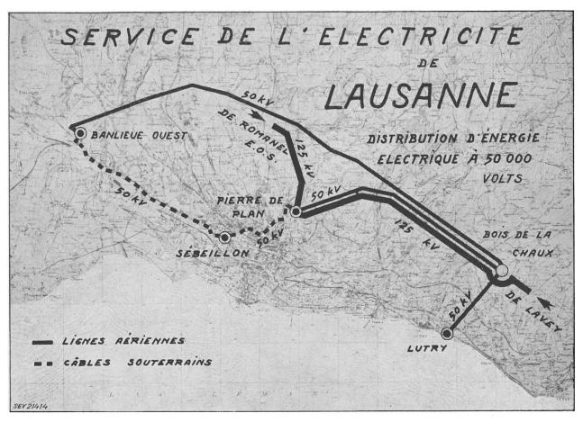
Fig. 1 Superréseau de distribution à 50 kV, état 1953
