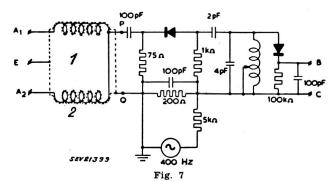
Schaltung für Strahlungsmessungen A<sub>1</sub>, A<sub>2</sub> Antennenbuchsen des Empfängers; E Erde;
