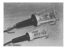
sennippel versehen. Zugentladungsbride vorhanden. Die Handlampen sind z. T. mit Schutzglas und Blende versehen. Die Handlampen haben die Prüfung in sicherheitstechnischer Hinsicht bestanden. Verwendung: in feuchten Räumen. Gültig bis Ende September 1956.
