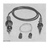
stungsmesser mit Skalen für max. 250 V  $\sim$  und 85 W  $\sim$ , die andere einen Druckkontakt, eine Fassung für Glimmstarter und einen Unterbrechungskontakt. Letzterer wird beim Einsetzen eines Starters oder der Verlängerungsschnur, welche zur Prüfung von Lampenkathoden auf Unterbruch dient, betätigt.
