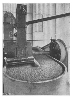
Der Holländer Hier vollzieht sich die eigentliche Mischung des Asbestzementbreies
