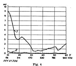
Unterschied zwischen den Streufeldern zweier Röhren mit verschiedenen Aussenschichten
