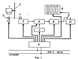
1 Motor; 2 Lichtquelle; 3 Windflügel; 4 Photozelle; 5 Verstärker; 6 elektronischer Unterbrecher; 7 Zeitschaltwerk; 8 Impulsausgleicher; 9 elektronischer Zähler; 10 Kontrollsender; 11 Spannungsquellen
