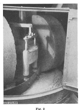
Der Kollergang Schwere Granitsteine schliessen durch Mahlung den Asbest in die einzelnen Fasern auf
