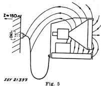
Das Entstehen asymetrischer Netzstrahlung
