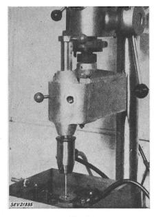
Fig. 2 Elektrodenhalter mit eingebautem, elektronisch gesteuertem, umschaltbarem Antriebsmotor mit Zahnraduntersetzung Die Bohrspindel rotiert nicht
