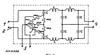
Fig. 6 CISPR-Filter zur Messung der Netzstrahlung  $L=500~\mu H~\pm~10~\%;~C=~0.1~\mu F~\pm~10~\%,~800~V$  1 Fernsehempfänger; 2 Kabel 5 m, nicht abgeschirmt; 3 Instrument zur Messung der Feldsträrke; 4 Netzanschluss
