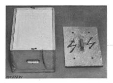
rung der Schutzrohre versehen. In die Gipsmasse sind Asbestschnüre eingelegt. Innenmasse des Kastens:  $320\times205\times155$  mm. Wandstärke ca. 18 mm. Äussere Abmessungen:  $385\times260\times185$  mm.
