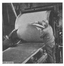
Fig. 5 Mittels eines Holzmessers schneidet der Maschinenmeister längs einer Nut in der Formwalze die Stoffbahn auf
