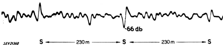
Fig. 20 Rückflußspannungen auf einem Koaxialkabel 2,64/9,52 mm, herrührend von einem \sin^2 -förmigen Sendeimpuls mit einer Halbwertzeit von 0,05 \mu s Abszisse: Entfernung vom Kabelanfang Ordinate: Rückflussschwankung A_r = 20 \cdot \log \frac{2 Z_0}{\Delta Z}
