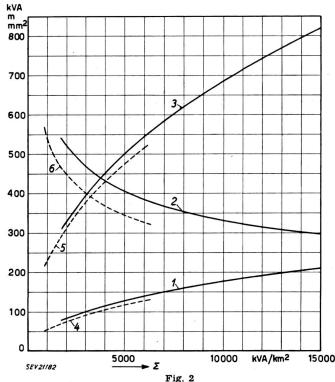
Ökonomische Transformatorleistung, Stationsabstand und Kabelquerschnitt eines schematisierten Netzes
