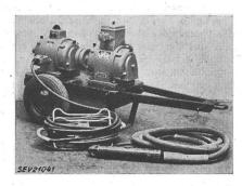
erregter Asynchrongenerator mit Kurzschlussanker, spritzwassergeschützt, ventiliert. Tauchnadel mit eingebautem Drehstrom-Kurzschlussankermotor und Exzenterrotor. Am Generator können auch Spezialwerkzeuge mit flexibler Welle angeschlossen werden. Der Motor ist von den übrigen Teilen isoliert montiert. Anschluss über Industriekontakt.
