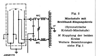
Eingangskreise erhöht werden. Fig. 1 stellt eine einfache Kristallmischstufe dar, während Fig. 2 eine symmetrische Mischanordnung mit zwei Kristallen zeigt.
