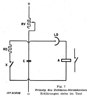
Kondensator C auf die Zündspannung der Glimmröhre aufgeladen. Die Röhre LD zündet und das mit ihr in Serie angeordnete Relais A spricht an.
