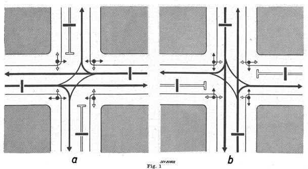
Regelung der Verkehrsflüsse in 2 Phasen a und b an einer gewöhnlichen Strassenkreuzung Der Abbiegeverkehr nach links stört den Verkehr geradeaus. Die Fussgänger sind nicht berücksichtigt
