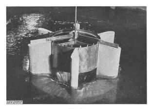
Fig. 5 Modèle de l'évacuateur du barrage de Pracana. Déversement d'un débit correspondant à 1000 m³/s
