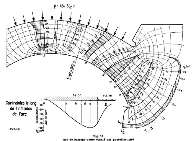
Lignes isostatiques et distribution des contraintes dans l'arc et dans le rocher d'appui, déduites de l'expérience
