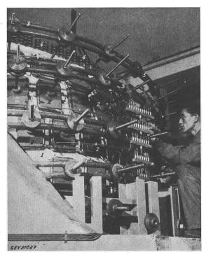
Fig. 15 Dispositif de charge pour l'étude statique d'un modèle de barrage-voûte
