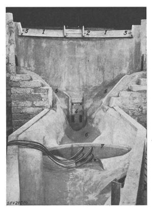
Fig. 1 Modèle du barrage du Châtelot
