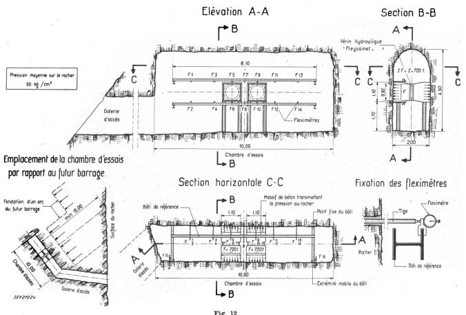
Schéma de l'installation utilisée pour la détermination du module de déformation du rocher
