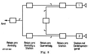
Blockschema einer Relaislinienwähleranlage
