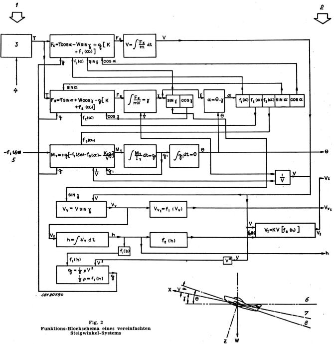
1 Bedienungshebel des Piloten; 2 Ausgänge für Instrumentalanzeigen; 3 Schubkraft vom Triebwerk-Rechner; 4 Gas- und übrige Triebwerk-Bedienungshebel; 5 vom Höhensteuer; 6 Horizontale; 7 Flugbahn; 8 Flugzeug-Längsachse
