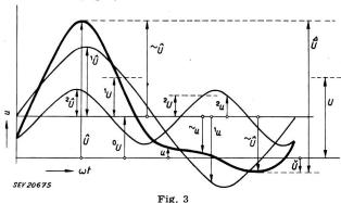
Fall c Reine Wechselschwingung  ${}^{0}U = 0$  (Fig. 4).
