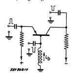
In diesem Moment wird der Kondensator rasch über den Transistor entladen und erzeugt in jeuem. Sägezahn-Schwingung. N. Schaetti zeugt in jedem Zyklus eine
