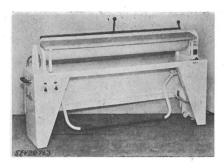
ankermotor über Keilriemen und Getriebe. Gestell aus Blech. Schalter für Heizung und Motor sowie Signallampe eingebaut. Fusshebel zum Abheben der Heizplatte von der Walze. Handgriffe isoliert. Vieradrige Zuleitung mit  $3\,\mathrm{P} + \mathrm{E}$ -Stecker, fest angeschlossen.
