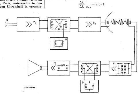
liegt in der absoluten Geheimhaltung nach aussen, indem der ausgestrahlte Ultraschall auf das Lokal beschränkt wird, im Gegensatz zur radioelektrischen Übermittlung. Das Prinzip einer solchen Übertragung ist in Fig. 1 dargestellt. Dabei werden nur die beiden Seitenbänder übertragen. Die Trägerfrequenz liegt zwischen 16 und 100 kHz. Da die Leistung durch den elektroakustischen Wandler beschränkt ist, wurde
