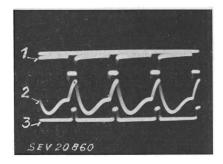
Fig. 3 Mit Hilfe des vierfachen Elektronenschalters aufgenommenes Oszillogramm
