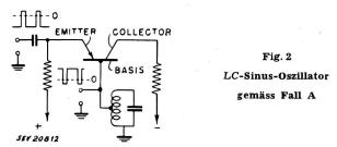
bei der Resonanzfrequenz des abgestimmten Schwingkreises. Inbezug auf die Basis ist der Kollektor in entgegengesetzter, der Emitter in gleicher Richtung vorgespannt. Beide, Emitter und Kollektor, könnten direkt mit der Spannungsquelle verbunden sein, doch sind in Hinsicht auf die Strombegrenzung verschiedener Transistoren Widerstände notwendig.
