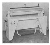
Antrieb der Walze durch gekapselten Drehstrom-Kurzschlussankermotor über Keilriemen und Getriebe. Gestell aus Blech. Schalter für Heizung und Motor sowie Signallampe eingebaut. Fusshebel zum Abheben der Heizplatte von der Walze. Handgriffe isoliert. Vieradrige Zuleitung mit 3 P + E-Stecker, fest angeschlossen.
