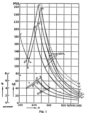
Maximalwerte der Leistung P in MVA und entsprechende Werte der «inertia constant» H
