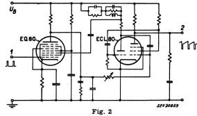
Vereinfachtes Schaltschema der Schwungradsynchronisier-schaltung mit EQ80 und ECL80
